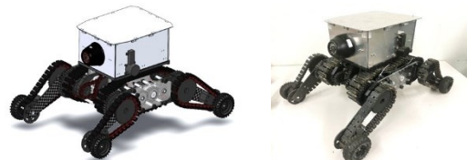
(a) 4 輪走行形態のモデル図 (左) と実機 (右)
