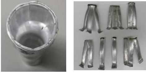
図3 管材の爆発圧着後の試料（左：部分的に成功した例, 右:接合したものの試料が破損した例）
