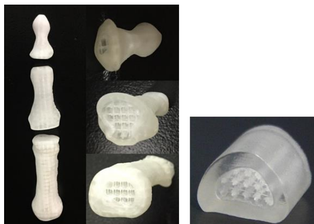
図4 3Dプリンターで造形した指骨構造体
