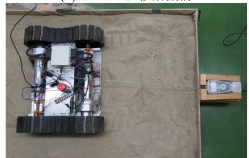
(c) 車体駆動力計測実験装置
